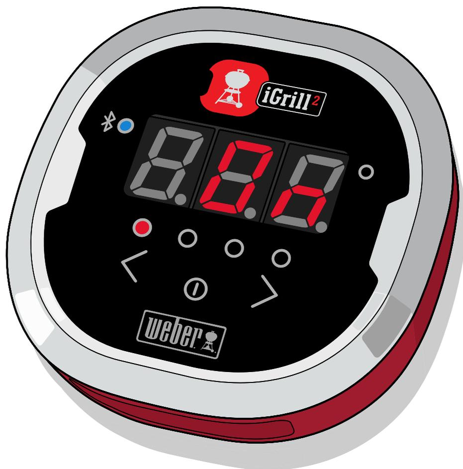
Al insertar las pilas, el iGRILL 2 mostrará automáticamente el mensaje “On” y emitirá un aviso acústico.
