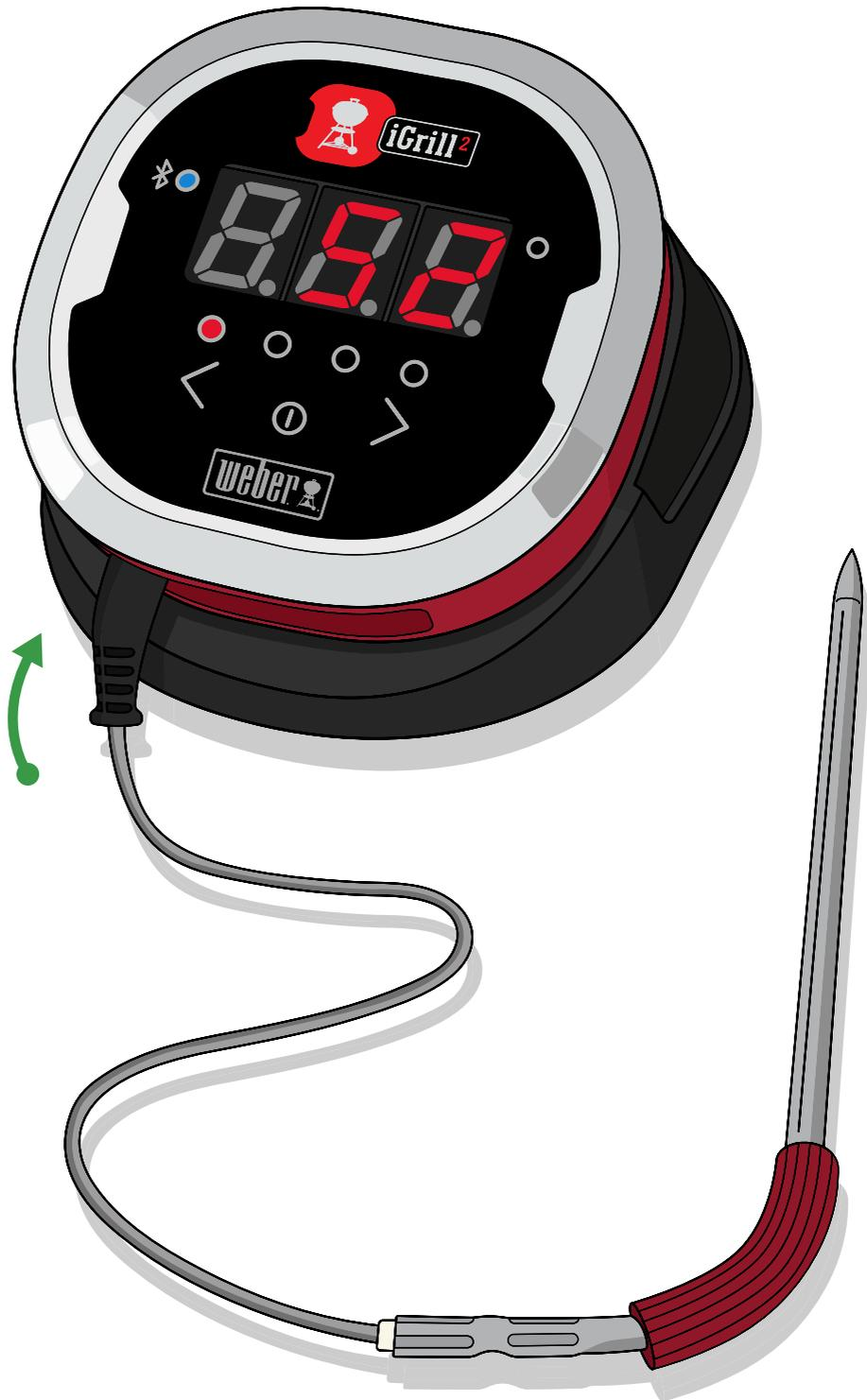
Conecte una o más sondas a los conectores.
