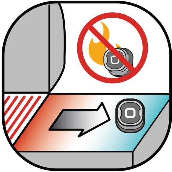
NOTA: La base magnética no está diseñada para soportar mucho calor; por ello, es recomendable colocarla en una superficie fría. ¡Si la superficie está demasiado caliente al tacto, entonces estará demasiado caliente para la base del Weber® iGrill®!
